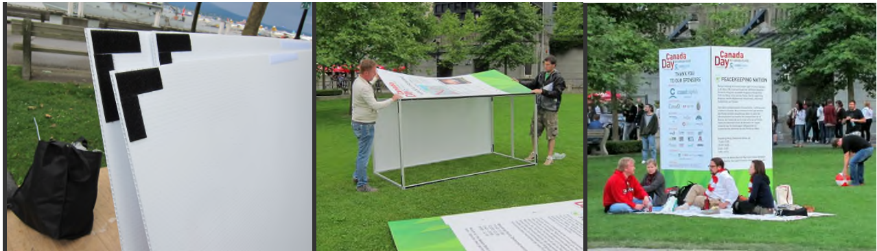
Herstellung eines Aufstellers aus Alu-Rahmen, verkleidet mit digital bedruckten Europrop-Stegplatten. Befestigung mittels selbstklebenden Klettbanden (Haken-/Flausch-Bänder)
